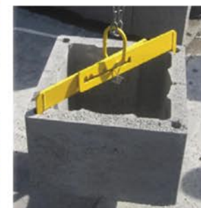
Универсальный захват для тяжелых каменных блоков
