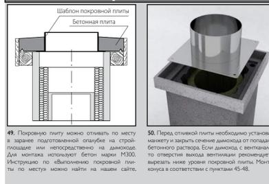
49. Покровную плиту можно отлить по месту в заранее подготовленной опалубке на строительном или непосредственно на месте. Для монтажа используйте бетон марки М300. Инструкцию по изготовлению покровной плиты по месту можно найти на нашем сайте.
