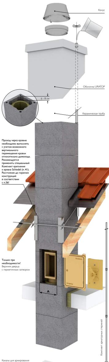
Проклад через кровлю необходимо выполнить с учетом возможного вертикального перемещения кровли относительно дымохода. Рекомендуется применять специальный Комплект крепления к кровле Schiedel (рис. 41). Расстояние до горючих конструкций в соответствии с п.36!
